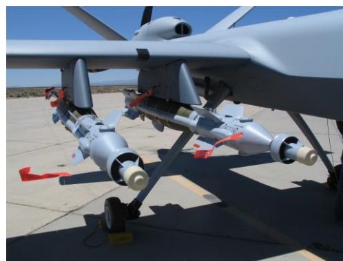
Fig. 1. Bomba GBU-49, guiada por laser e GPS/INS, pertencente à família Paveway II, montada no UAV MQ-9 Reaper.
