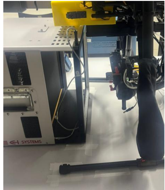
Fig. 1. Montagem do ensaio: câmera WIRIS Pro a cerca de 20 cm da abertura do corpo negro CI Systems SR800-12D.
