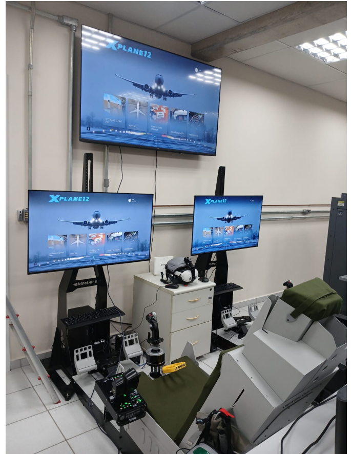
Fig. 2. Estações de voo para pilotagem de aeronaves no X-plane integrada ao emulador de sinais radar EWAS para geração em tempo real de sinais radar até 40 GHz.
