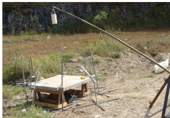
Fig. 2. Dispositivo do ensaio com laje, explosivo e sensores de pressão posicionados.
