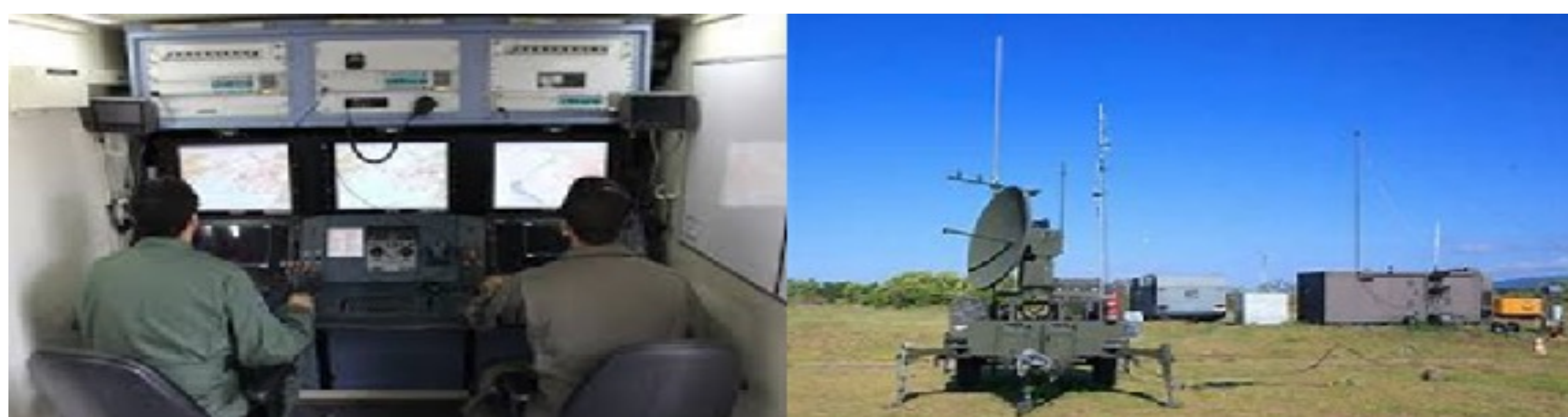
Fig. 1. Estação de Controle de Solo do SARP.
