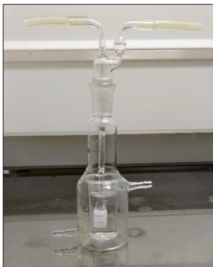
Fig. 2. Câmara de vidro utilizada para aplicação do ozônio na água.
